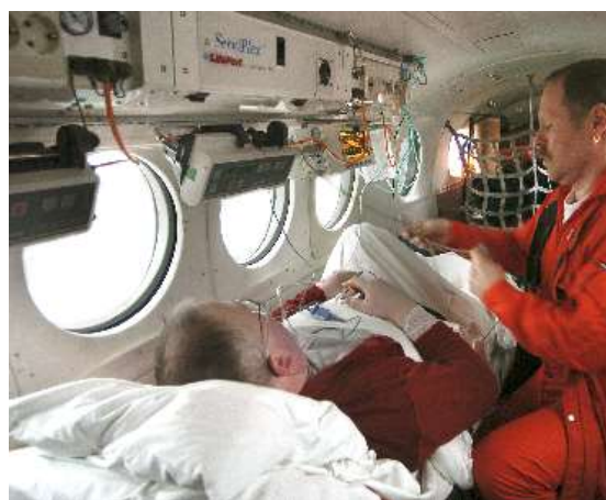
Figur 2 Pasient på plass tilkoblet transportmonitor og sprøytepumper montert til skinne i taket.
